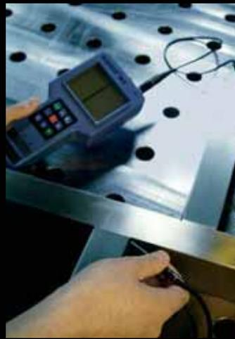
Schweißnahtprüfung mittels Wirbelstrom
