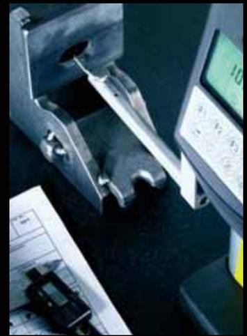
Masskontrolle an Schweißkonstruktion
